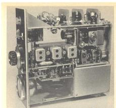
Bild 48. Innenansicht der 2-m-Station von DL 9 AL mit Zf-Baustein
