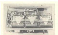
Bild 41. Unterbringung der Batterien unter dem Chassis
