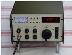
Neukonstruktion DK4SX, mit Umschalter FM/SSB und Relaisablage
