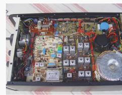
Blick unter das Chassis: Empfänger mit Frontend, ZF, Netzteil mit Ringkerntrafo, NF Verstärker auf dem FM Demodulator
