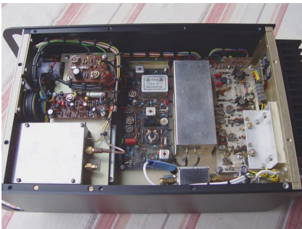
Neukonstruktion des SSB/FM-2m-Transceivers aus SEMCO-Bausteinen
