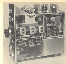
Bild 44. Innenaussicht der 2-m-Station von DL9AL mit Zf-Baustein
