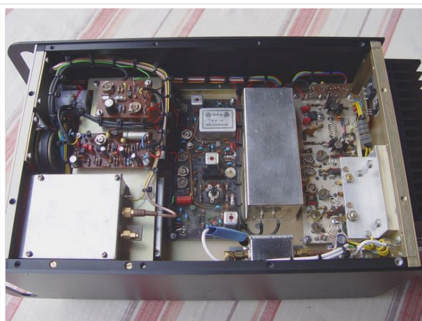
Neukonstruktion des SSB/FM-2m-Transceivers aus SEMCO-Bausteinen
