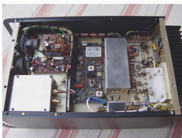
Neukonstruktion des SSB/FM-2m-Transceivers aus SEMCO-Bausteinen
