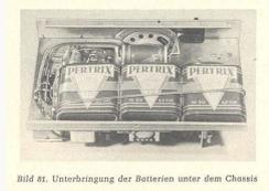
Unterbringung der Batterien unter dem Chassis DJ5MM
