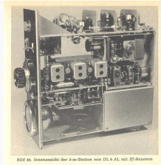
2m Station von DL9AL mit Zf-Baustein
