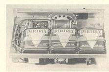
Bild 41. Unterbringung der Batterien unter dem Chassis
