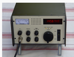
Neukonstruktion DK4SX, mit Umschalter FM/SSB und Relaisablage
