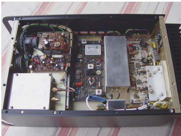
Neukonstruktion des SSB/FM-2m-Transceivers aus SEMCO-Bausteinen
