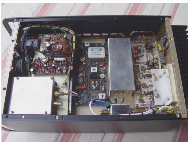
Neukonstruktion des SSB/FM-2m-Transceivers aus SEMCO-Bausteinen
