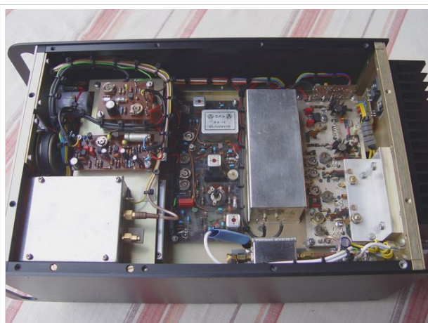
Neukonstruktion des SSB/FM-2m-Transceivers aus SEMCO-Bausteinen
