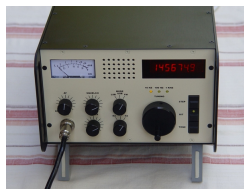
Originales SEMCO- SSB, getrennte FM /SSB Einstellung für TX und RX, BFO- Abstimmung. Alle Bilder: Uli, DK4SX
