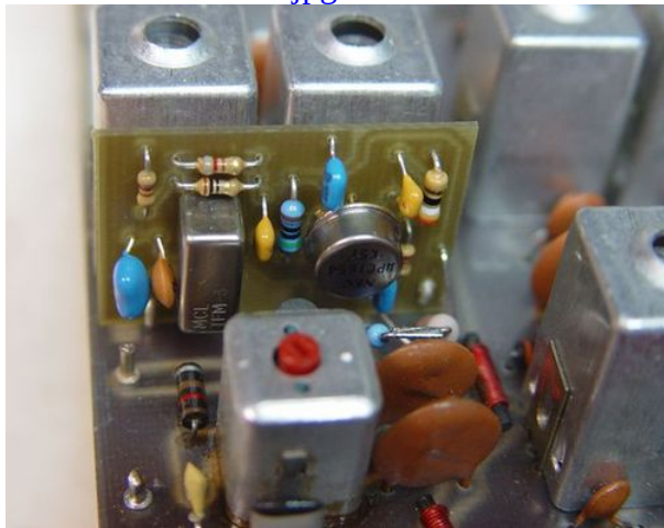
Zusatzplatine auf dem Konvertermodul mit TFM- 3 Diodenmischer und +7 dBm-LO-Verstärker
