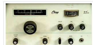
Clegg VHF-AM- Transceiver 22'er
