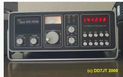
Tischgerät SE 402, FM, SSB, CW; Pout: 10 W (1977)
