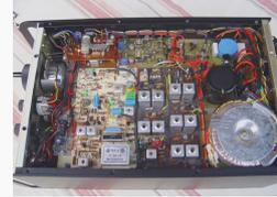
Blick unter das Chassis: Empfänger mit Frontend, ZF, Netzteil mit Ringkerntrafo, NF Verstärker auf dem FM Demodulator
