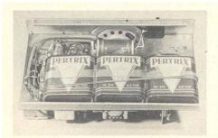
Bild 42. Unterbringung der Batterien unter dem Chassis
