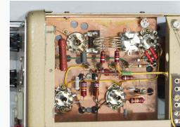
20 Watt input, A/G2 Mod, Bandfilterkopplung in allen Stufen, vier Si-Dioden im Netzteil.
