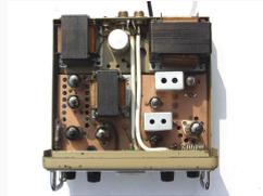
Quarzgesteuerter CW /AM Sender für das 2m Amateurband.
