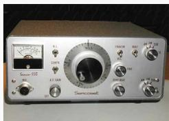
Originales SEMCO-SSB, getrennte FM/SSB Einstellung für TX und RX, BFO-Abstimmung
