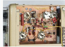
20 Watt input, A/G2 Mod, Bandfilterkopplung in allen Stufen, vier Si-Dioden im Netzteil.
