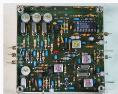
Ursprünglich war der BFO des Empfängers freischwingend - nun mittels Quarzfrequenz erzeugt
