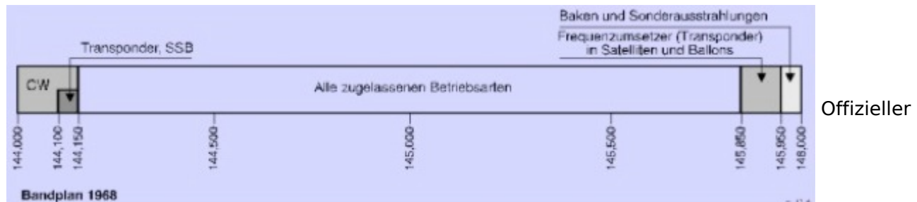
Bandplan für das 2 Meter Band 1968
