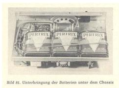
Unterbringung der Batterien unter dem Chassis DJ5MM
