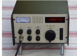
Neukonstruktion DK4SX, mit Umschalter FM/SSB und Relaisablage
