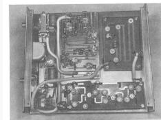
Bild 92. Innenansicht des 70cm-Zusatzgerätes von DL 6 MH.
