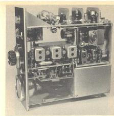
Bild 48. Innensicht der 2-m-Station von DL 9 AL mit Zf-Baustein
