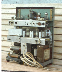
Rückansicht des OE7IW Gerätes, Nuvistor 2m Tuner in den 50-60er Jahren
