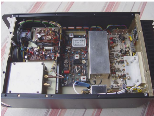
Neukonstruktion des SSB/FM-2m- Transceivers aus SEMCO-Bausteinen
