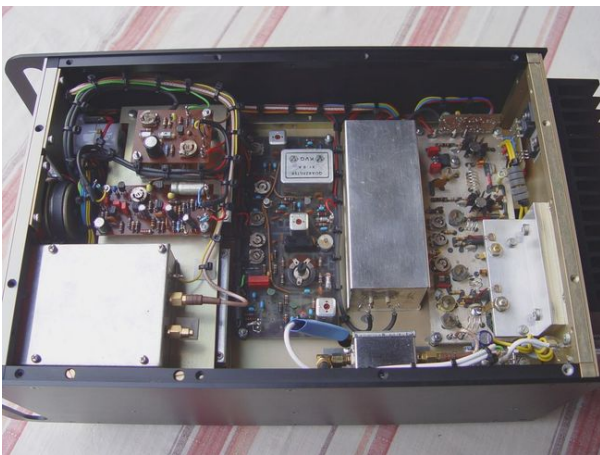
Neukonstruktion des SSB/FM-2m-Transceivers aus SEMCO-Bausteinen
