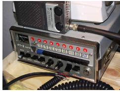
• Yaesu FT-2 AUTO, 1972 der Nachfolger des FT-2 mit acht Quarzkanälen, Priority- und Scanfunktion!
