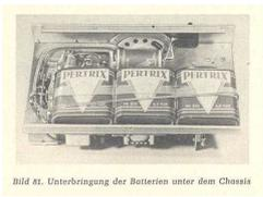
Unterbringung der Batterien unter dem Chassis DJ5MM
