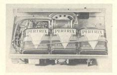
Bild 21. Unterbringung der Batterien unter dem Chassis
