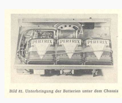
Unterbringung der Batterien unter dem Chassis DJ5MM
