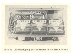
Unterbringung der Batterien unter dem Chassis DJ5MM
