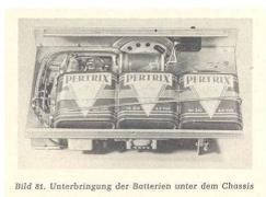
Unterbringung der Batterien unter dem Chassis DJ5MM
