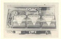
Bild 41. Unterbringung der Batterien unter dem Chassis
