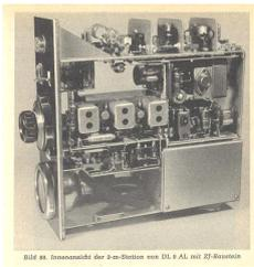
Bild 48. Innenansicht der 2-m-Station von DL 9 AL, mit Zf-Baustein
