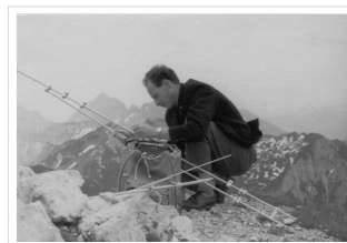
Zusammenbau der Langyagi am Berg
