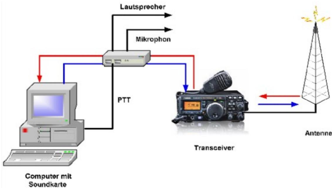
Diese werden zwischen Computer (Soundkarte) und Transceiver geschaltet und bieten Umschaltmöglichkeiten zwischen Voice-Betrieb und Digi-Mode, Mithören ein/aus, usw. Da beim Senden der Transceiver ja idealerweise vom PC aus getastet wird, bieten diese Interfaces zumeist auch eine oder mehrere Möglichkeiten, die PTT zu bedienen. (Es ist zwar möglich, die PTT direkt von Hand zu bedienen, aber das ist auf Dauer zu mühsam und daher nur zu ersten Testzwecken empfehlenswert)
