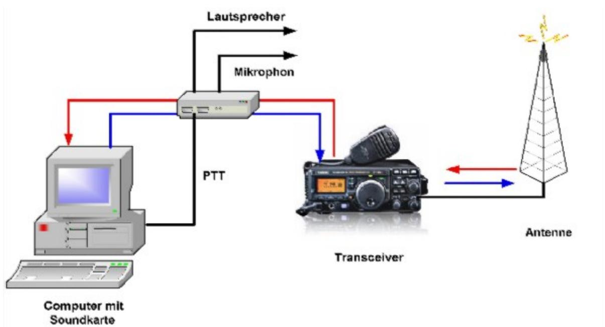
Diese werden zwischen Computer (Soundkarte) und Transceiver geschaltet und bieten Umschaltmöglichkeiten zwischen Voice-Betrieb und Digi-Mode, Mithören ein/aus, usw. Da beim Senden der Transceiver ja vom PC aus getastet werden muss, bieten diese Interfaces zumeist auch eine oder mehrere Möglichkeiten, die PTT zu bedienen.
