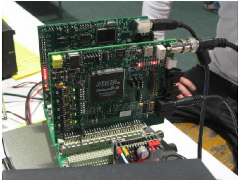
Mit **Software-Defined Radio (SDR)** beschreibt man das Bestreben, möglichst die gesamte Signalverarbeitung eines
