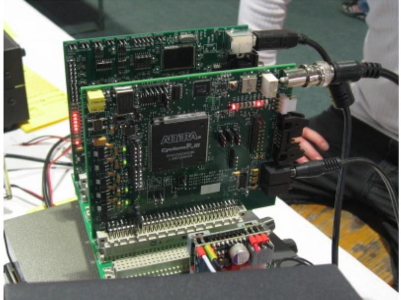
Mit **Software-Defined Radio (SDR)** beschreibt man das Bestreben, möglichst die gesamte Signalverarbeitung eines Funksystems von der unflexiblen und teuren Hardware in Richtung einer flexibel konfigurierbaren Software zu verlagern. SDR ermöglicht so einen sehr preisgünstigen Einstieg in den Amateurfunk.
