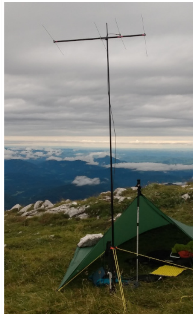
4 Element Yagi gebaut von OE5JFE
