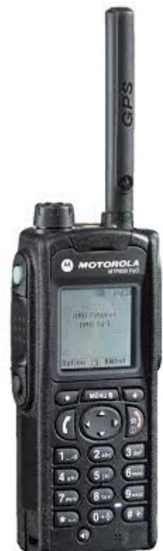
als „Umsetzer“ betreiben ohne Duplexer und nur auf einer Antenne. Die Modulationsart TETRA hat vier Zeitschlitze definiert und eine Leistung von ca. 2 Watt portable und 10-15 Watt mobil. Im DMO-Betrieb können maximal 2 Zeitschlitze der 4 vorhandenen für die Kommunikation verwendet werden. Im TETRA DMO gibt es auch "full-rate" also wenn alle 4 Zeitschlitze werden verwendet, aber nur wenige Terminals können "full-rate" unterstützen.
