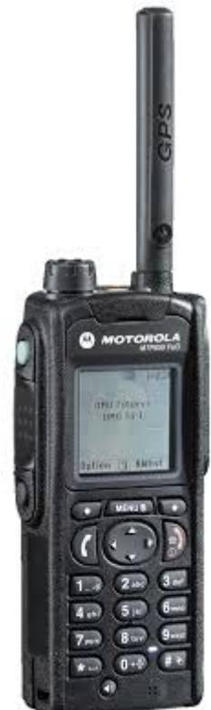
als „Umsetzer“ betreiben ohne Duplexer und nur auf einer Antenne. Die Modulationsart TETRA hat vier Zeitschlitzze definiert und eine Leistung von ca. 2 Watt portable und 10-15 Watt mobil. Im DMO-Betrieb können maximal 2 Zeitschlitzze der 4 vorhandenen für die Kommunikation verwendet werden. Im TETRA DMO gibt es auch "full-rate" also wenn alle 4 Zeitschlitzze werden verwendet, aber nur wenige Terminals können "full-rate" unterstützen.
