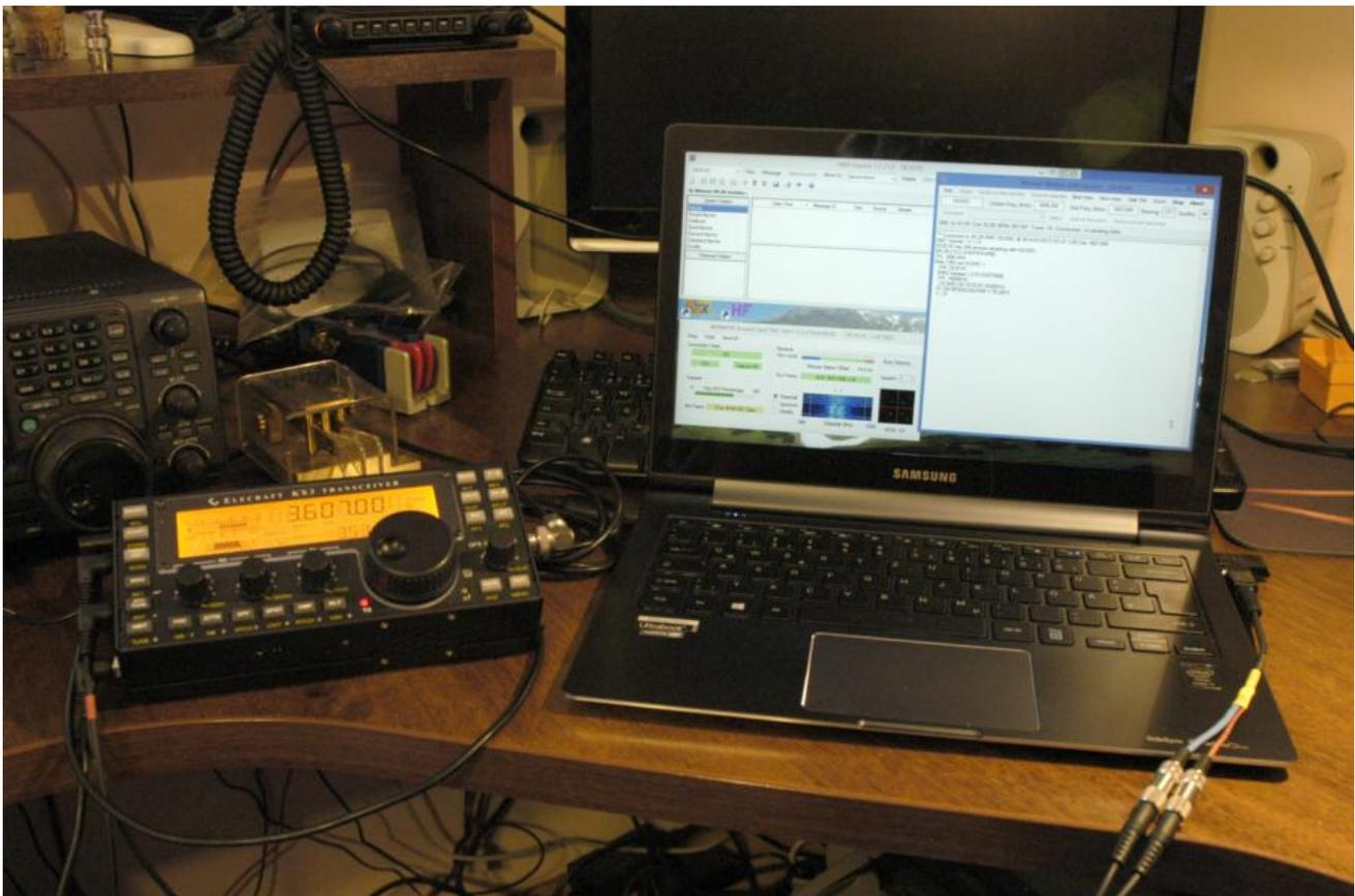
Hardware: KX3 Laptop (Samsung Ultrabook ATIV9) Audio-Splitterkabel für kombinierten Kopfhörer /Mikrofon-Ausgang Laptop (Anmerkung: Samsung verwendet auch die Apple-Belegung T:L, R1:R, R2:GND, S: Mic !!!) KX3USB-Kabel KX3-Receive und Transmit-Audio Kabel (jeweils Stereo-Kabel 3,5 Klinke)
