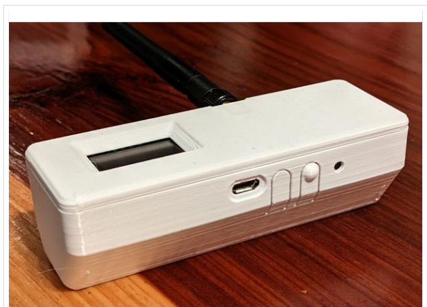
TBEAM Gehäuse mit Tasten und OLED
