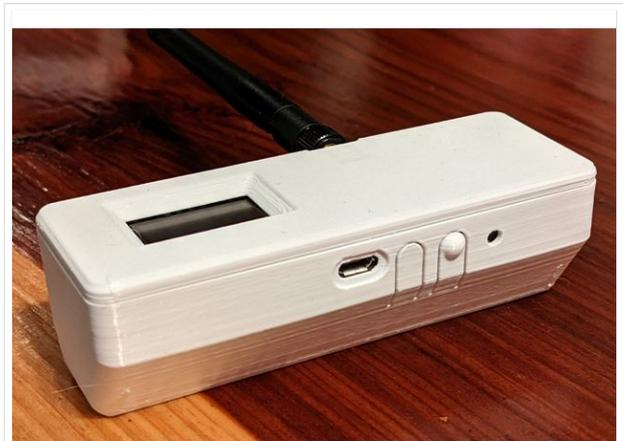
TBEAM Gehäuse mit Tasten und OLED
