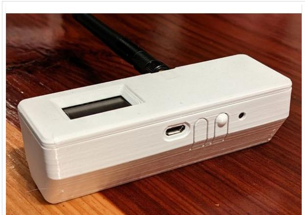
TBEAM Gehäuse mit Tasten und OLED
