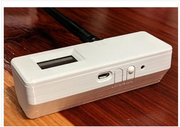
TBEAM Gehäuse mit Tasten und OLED
