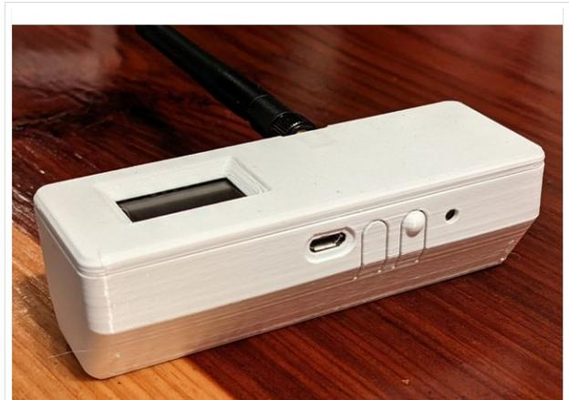
TBEAM Gehäuse mit Tasten und OLED
