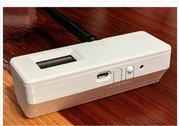
TBEAM Gehäuse mit Tasten und OLED
