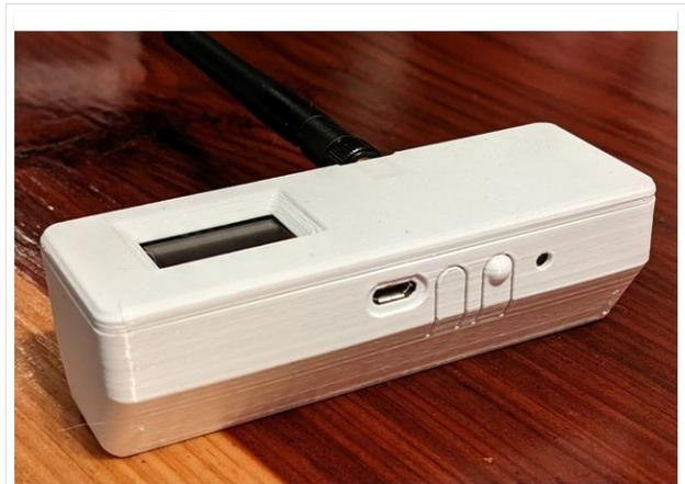
TBEAM Gehäuse mit Tasten und OLED
