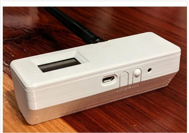
TBEAM Gehäuse mit Tasten und OLED
