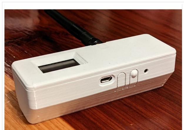
TBEAM Gehäuse mit Tasten und OLED
