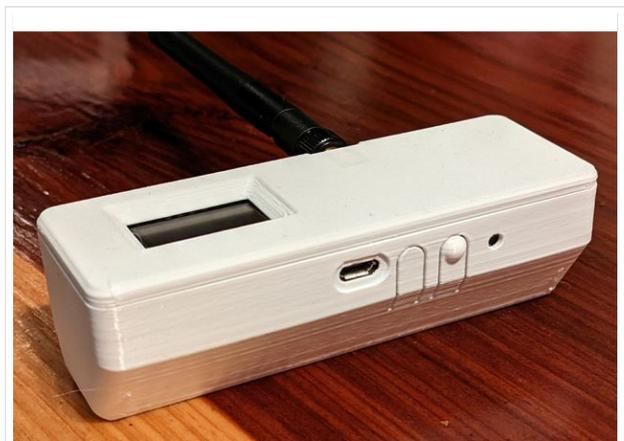
TBEAM Gehäuse mit Tasten und OLED
